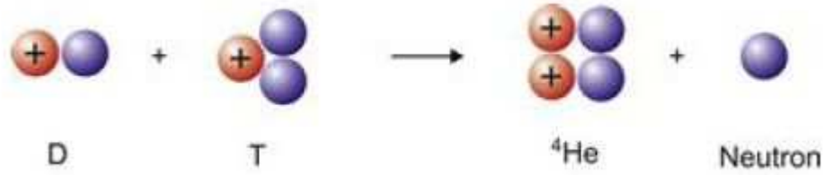
Figura 1.2: Reacción de Fusión nuclear entre un núcleo de deuterio y uno de tritio
